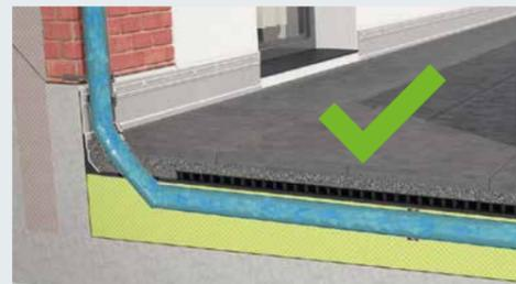
**Mit SitaKaskade** erzielen Sie dank des normkonformen Bauteilen-Systems einen sicheren Einbau und eine ästhetische Lösung: Das Rohr wird unsichtbar verlegt.
