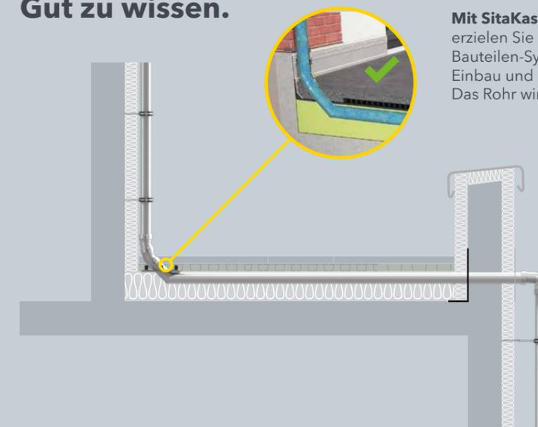
**Mit SitaKaskade** erzielen Sie dank des normkonformen Bauteilen-Systems einen sicheren Einbau und eine ästhetische Lösung: Das Rohr wird unsichtbar verlegt.
