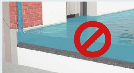
**Ohne SitaKaskade** besteht das Risiko der Überflutung tiefer liegender Flächen sowie statische Überlastung. Unfallgefahr droht durch über den Plattenbelag verlegte Abflussrohre.
